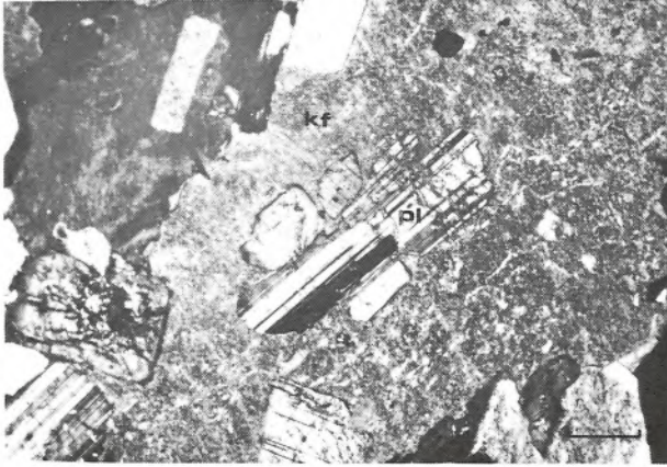
Şekil 16. Antirapakavi dokusunun genel görünümü (Şebinkarahisar-Dereli arasındaki granitoyid plütonundan alınan DŞ-69 no'lu kayaç örneği, çift nikol, çizgisel ölçek 0.25 mm) kf, K-feldispat; pl, plajiyoklaz.
