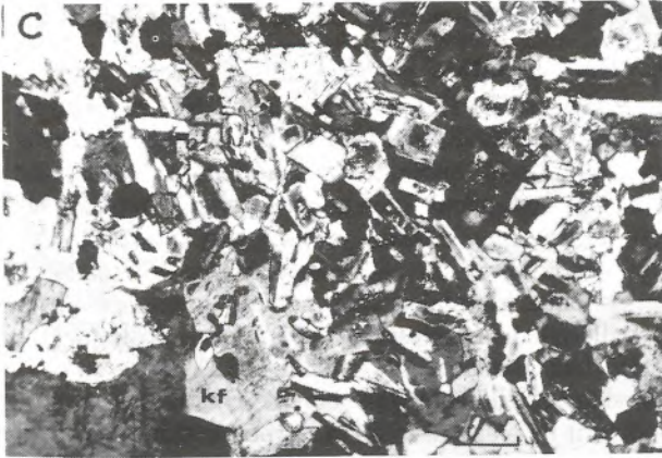
Şekil 10. Diyorit bileşiminde mikrogranüler dokulu bir MME örneğinin a. çift nikolde, b. tek nikolde genel görünümü. Aynı MME örneğinin, granodiyorit bileşimli taşıyıcı ana kayalık ile olan dokunağı ise c' de sol alt köşede görülmektedir. hb, hornblend; kf, K-feldispat (çizgisel ölçek 0.25 mm).
