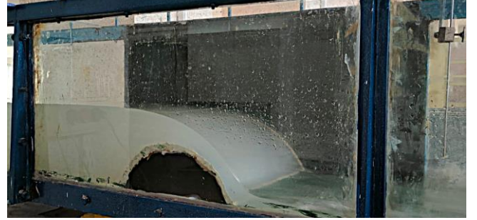
Şekil 8. P=0.125 ve L=0.32 m olan savak için yapılan deney
