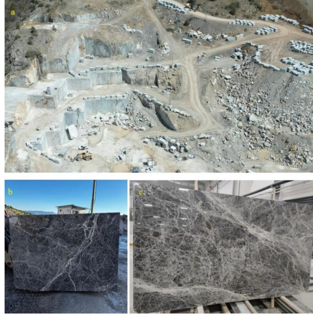
Şekil 3. Bağkonak Köyü çevresinde (a) üretim faaliyetinde bulunulan doğal taş ocağının, (b) ocaktan üretilen bir bloğun ve (c) Elegance Grey plakasının görünümü
