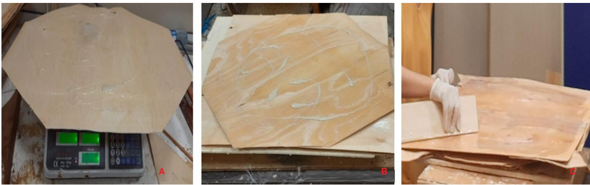
Şekil 2. Deney gruplarının Üretimi A) Tutkal miktarının ayarlanması, B) Tutkalın yüzeye uygulanması, C) Lif yönü.
