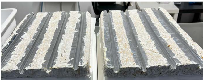
Şekil 7. Biyokompozit malzemenin büyümesiyle oluşan ipliksi dokular (Bayramoglu 2024)
