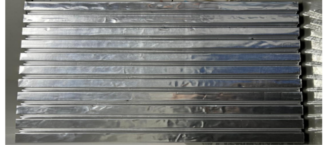
Şekil 8. 40X60X3,5 ölçülerinde Biopex Panel (Bayramoglu 2024)
