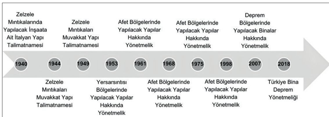
Şekil 3: Türkiye bina deprem yönetmeliklerinin gelişim süreci Figure 3: Development process of earthquake building design codes in Türkiye
