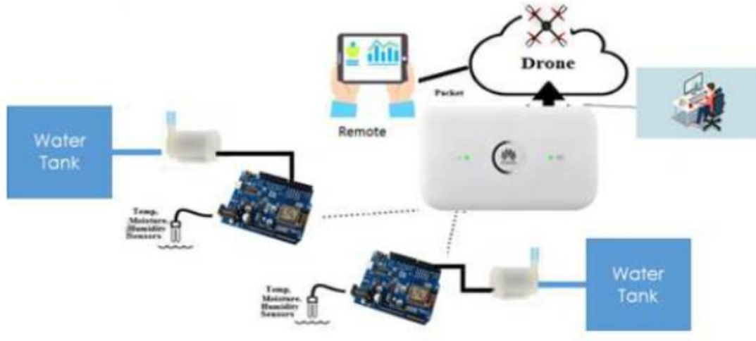
Grafik 2: IoT ve drone kullanan akıllı sulama sisteminin şematik diyagramı
