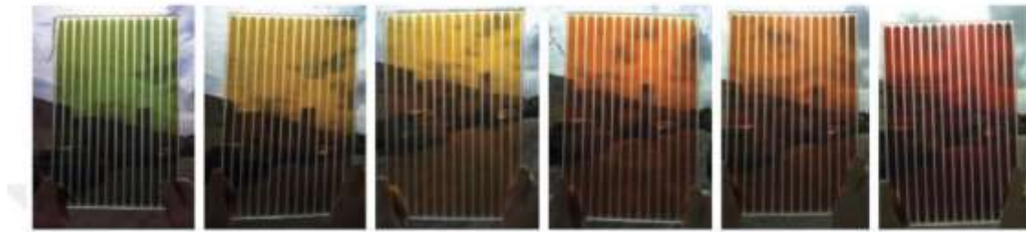
Şekil 33. Farklı renklerde üretilen boya duyarlı güneş panelleri (Bunoti, 2022).
