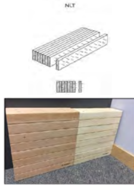
Görsel 8-9. NLT Malzemenin Çizimi (URL5), Farklı renk seçenekleri (Perkins ve Will, 2014)
