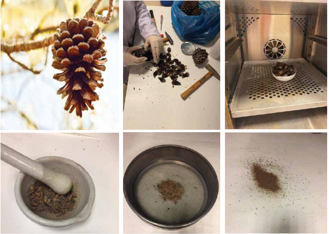
Şekil 2. Adsorban hazırlama ve adsorpsiyon basamakları.
