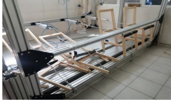
Şekil 7. Önden arkaya yüklenmiş deney sandalyelerinin tipik deformasyonu
