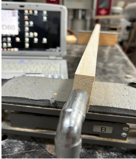
Şekil 2. Boyuna vibrasyon test düzeneği
