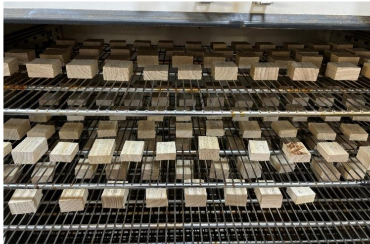
Şekil 4. Tahribatlı testlerden sonra kesilen yoğunluk ve rutubet örneklerinin kurutulması
