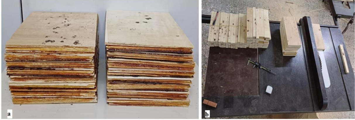
Şekil 1. Üretilen levhaların presleme sonrası görüntüsü (a), test örneklerinin hazırlanması (b)
