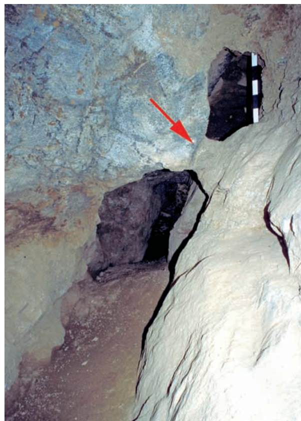
Abb. 7: Karnab, Grube 5-1. Auch im tieferen Bereich des Bergwerks schützten Bergfeste die Bergleute (Pfeil: Reste des Erzgangs).
