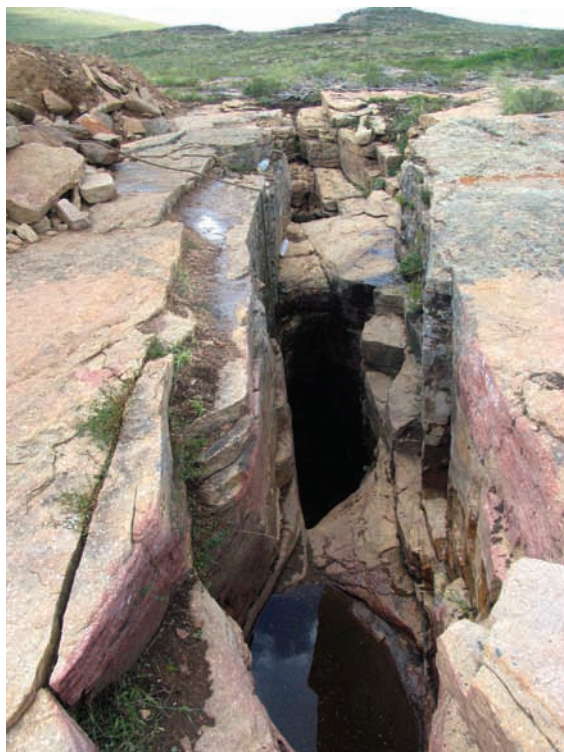
Abb. 23: Askaraly II. Die Grube baute einen steil stehenden Zinnerzgang ab.
