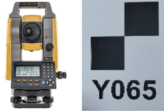
Şekil 3. Hassas Ölçüm Cihazı ve hedef işareti.
