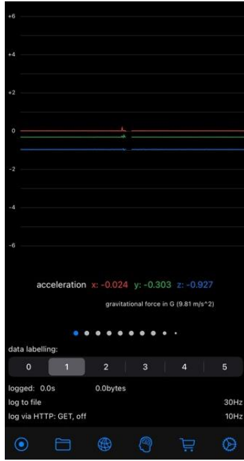
Şekil 3. SensorLog Uygulamasında Ham İvmeölçer Verilerinin Toplanması
