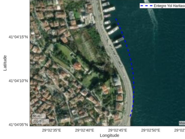
Şekil 6. GNSS (%95 Ağırlıklı) ve IMU (%5 Ağırlıklı) Verilerinin Entegrasyonu ile Oluşan Entegre Yol Haritası
