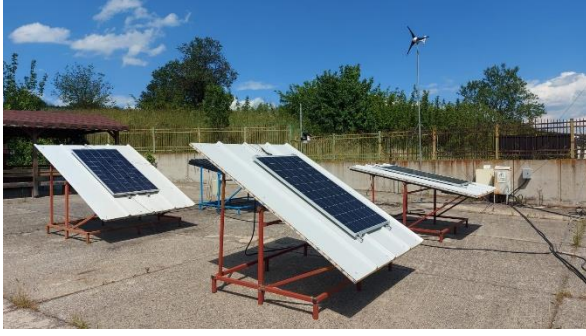
Şekil 14. Aynı eğim açılı polikristal ve monokristal silikon malzemeli PV paneller
