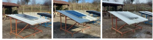
Şekil 5. Güneşli, gölgeli ve karlı hava koşullarında çalışan 10° eğim açılı PV panel
