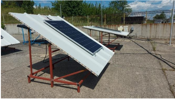
Şekil 15. Farklı eğim açılı monokristal silikon malzemeli PV paneller
