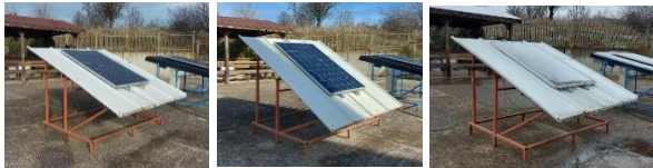
Şekil 3. Güneşli, gölgeli ve karlı hava koşullarında çalışan 30° eğim açılı PV panel
