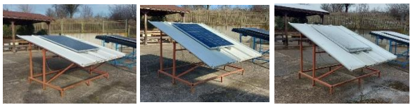
Şekil 3. Güneşli, gölgeli ve karlı hava koşullarında çalışan 30° eğim açılı PV panel
