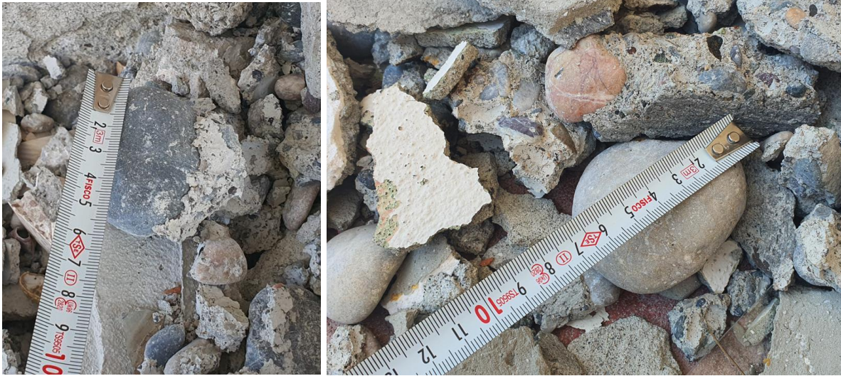
Şekil 7. Betonda uygun olmayan gradasyon
