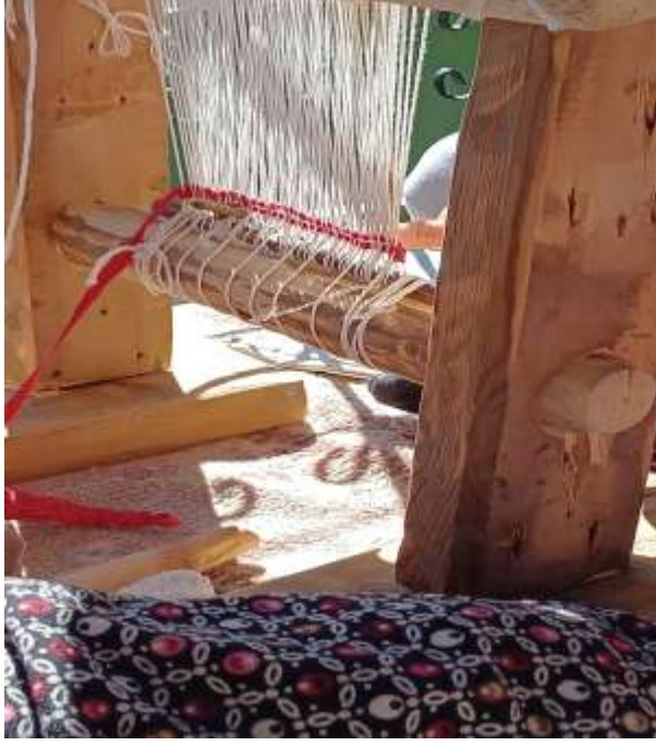
Görsel 9: Atık kumaştan iplerin (yatay ipler) tezgâhta dokumaya dönüşmesi. (Görsel yazarın şahsi arşivindendir).
