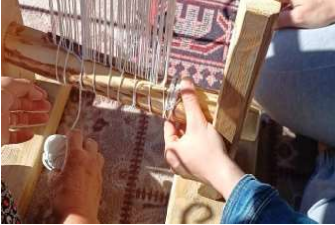
Görsel 8: İyilmiş iplerin ıstara geçirilerek bağlanması (kücüleme). (Görsel yazarın şahsi arşivindedir).
