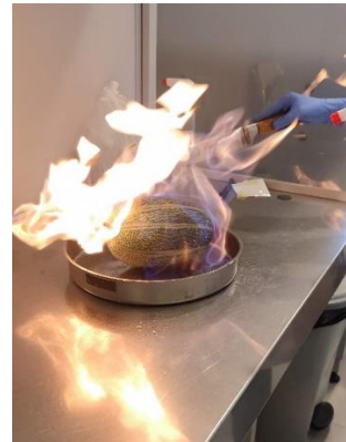
Şekil 3. Steril kabin içerisinde meyveyi yakma yöntemi ile sterilizasyon aşaması
