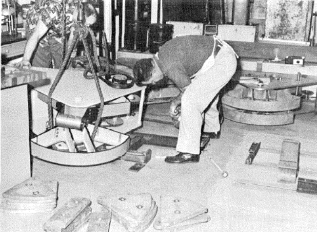
Şekil 6: Hudson (1961) tarafından geliştirilen sarsıcı cihaz.
