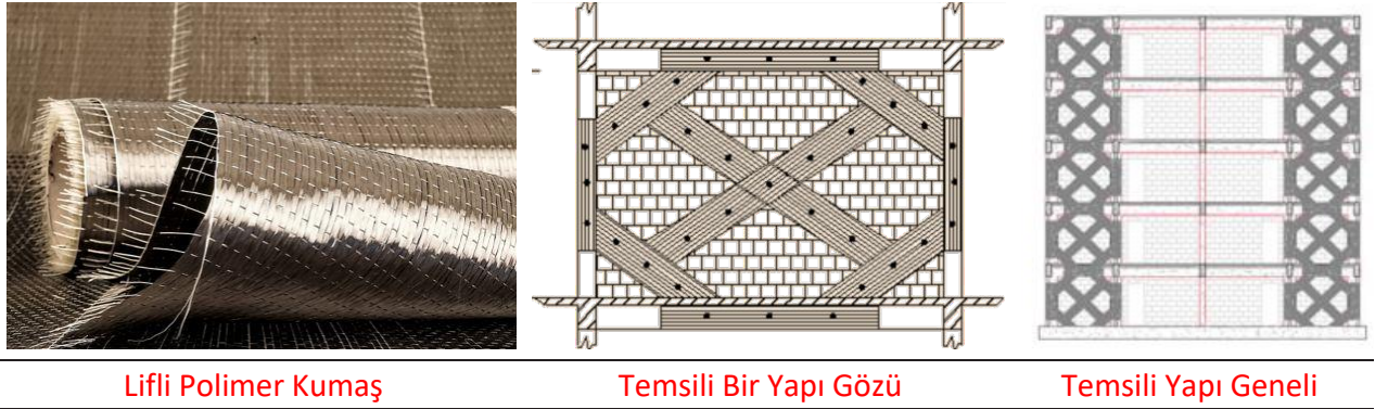
Şekil 3: Lifli polimer kumaş yapısal uygulamalar (Özkaynak, 2010).
