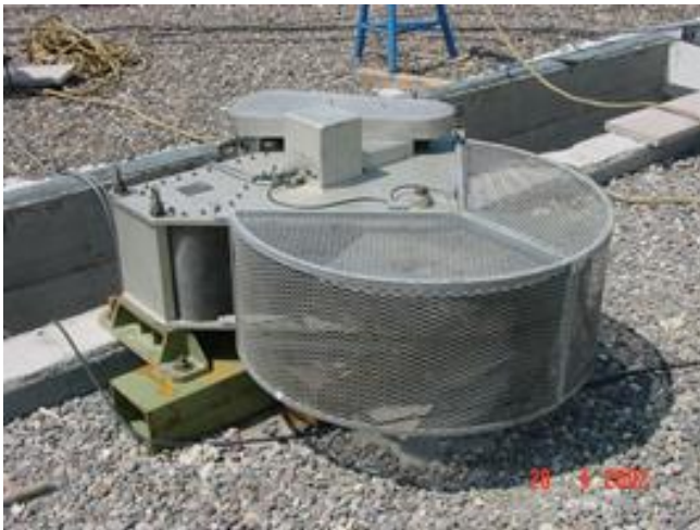
Şekil 8: Zorlanmış titreşim üreten cihaz ve uygulandığı yapı (Çelik vd. 2003).
