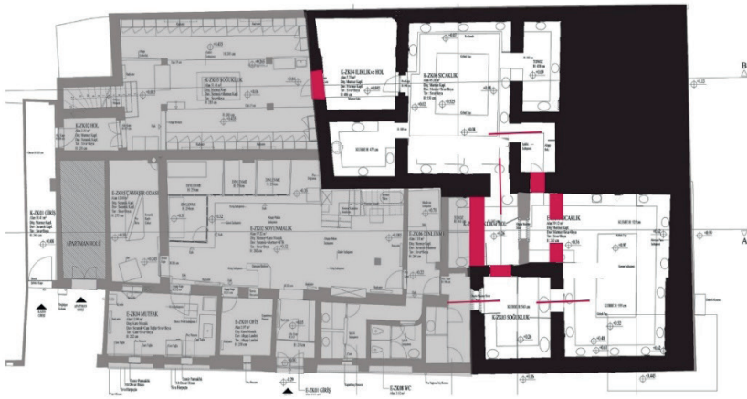
ortadan kaldırılmış duvar
