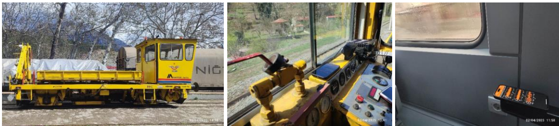
Şekil 1. Ölçüm sırasında cihaz yerleşimi: oto drezin dış görünüşü, kontrol paneli üzerindeki konum ve yolcu trenindeki sabitleme
