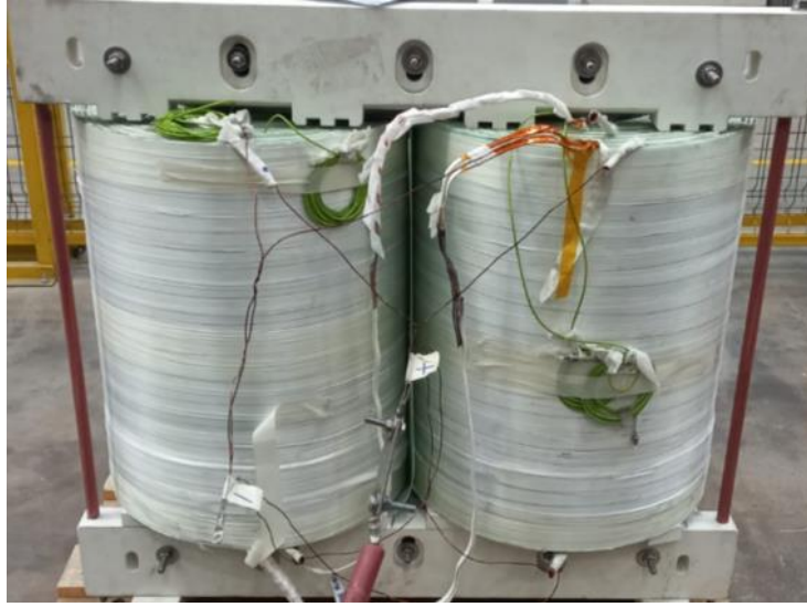
Şekil 8. Çalışmada incelenen cer transformatörü
