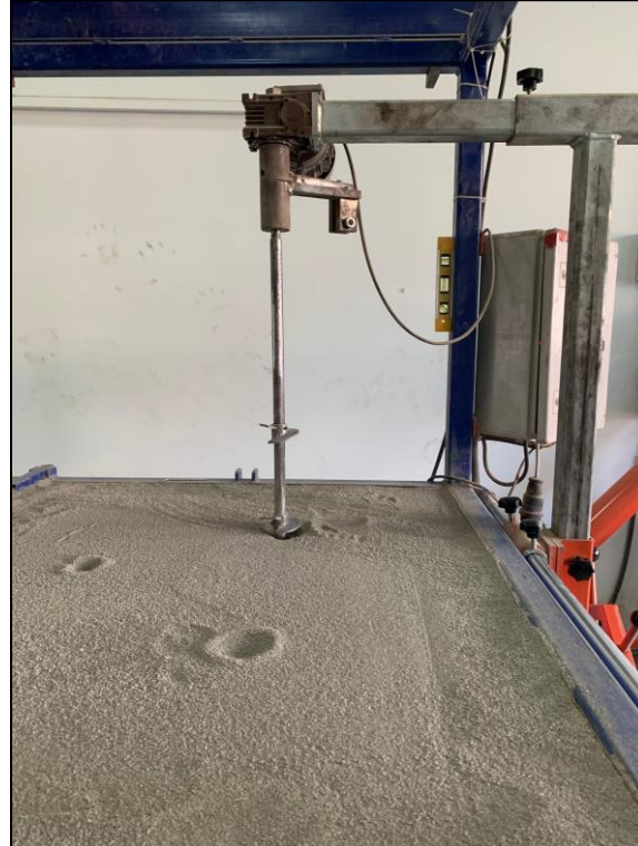
Şekil 4. Helisel Kazık Tork Motoru Montaj Düzeneği
