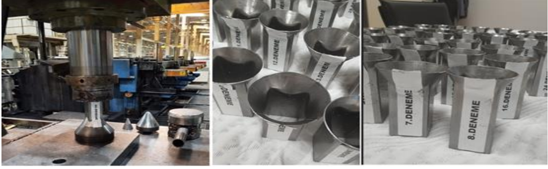
Şekil 3. Ağız Genişletme Deneyleri
