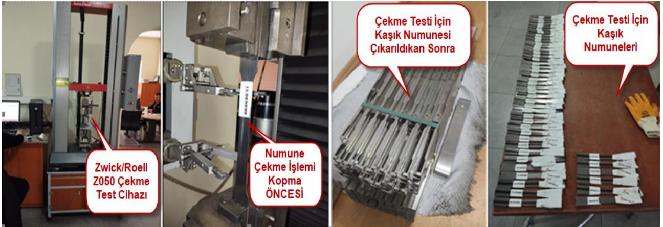
Şekil 5. Çekme Testi Deneyleri
