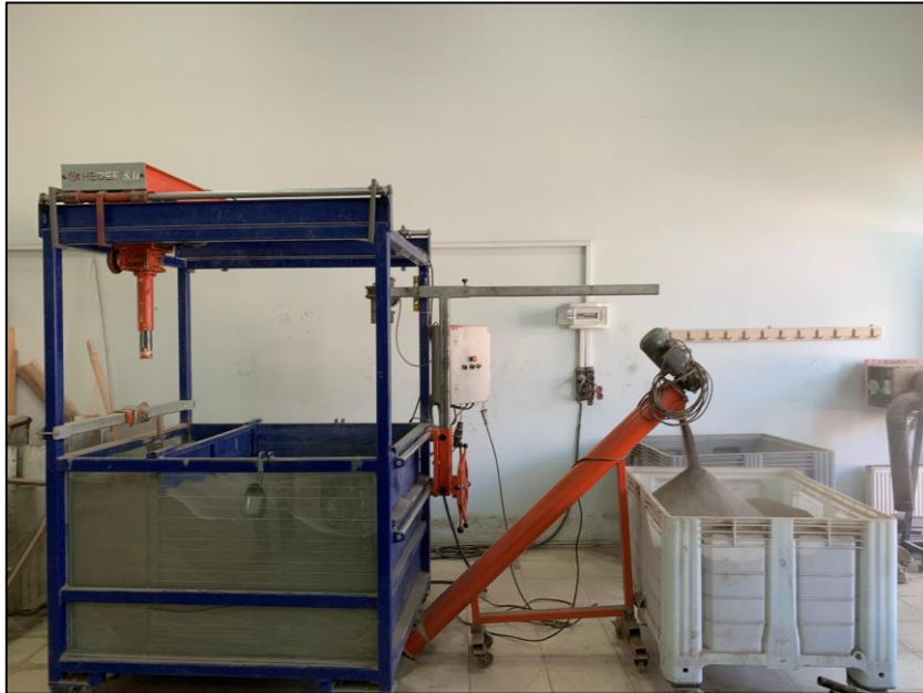
Şekil 2. Deney Kasası ve Helezon Sistemi
