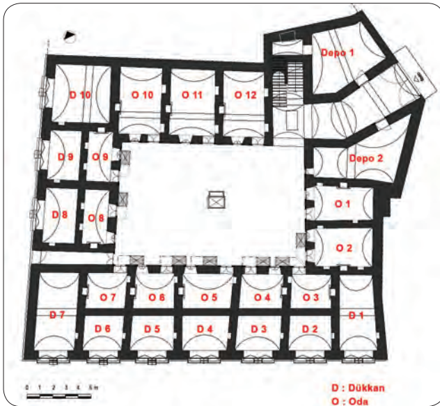
Şekil 3 - Muhsinzade Hanı, zemin kat restitüsyon / Muhsinzade Khan, groundfloor, restitution
