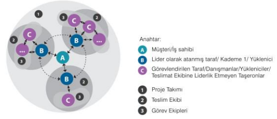
Şekil 1. ISO 19650 serisine göre proje ekibi ve tarafları (BSI izni ile çoğaltılmıştır.) -Türkçe çeviri-
