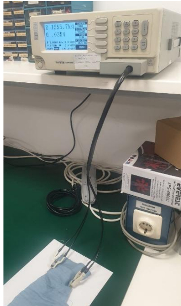
Şekil 13. GW Instek LCR-816 model LCRmetre ile direnç ölçümü Figure 13. Resistance measurement using the GW Instek LCR-816 model LCR meter
