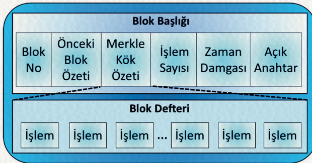
Şekil 4.3. Blokzincirindeki Bir Bloğun Veri Yapısının Temsili
