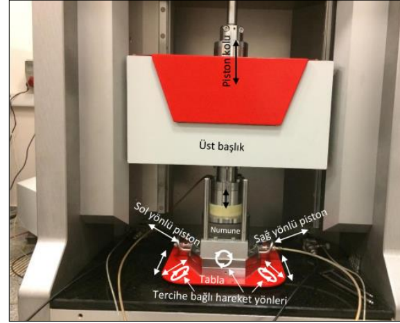
Şekil 8. Dinamik basit kesme deney düzeneğinin karşıdan görünüşü (Kahraman, 2021)
