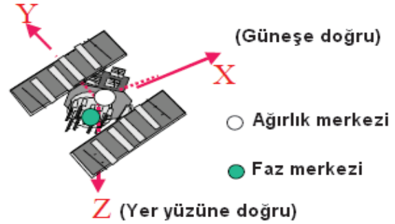
Şekil 2: Uydu anteni faz merkezi kayıklıkları
