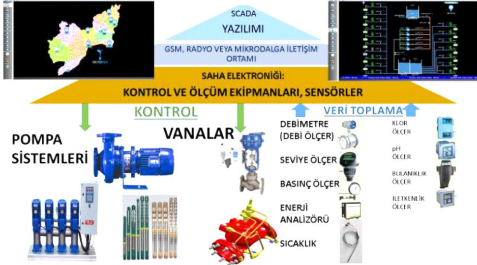
Şekil 1: İçme Suyu SCADA’sı
