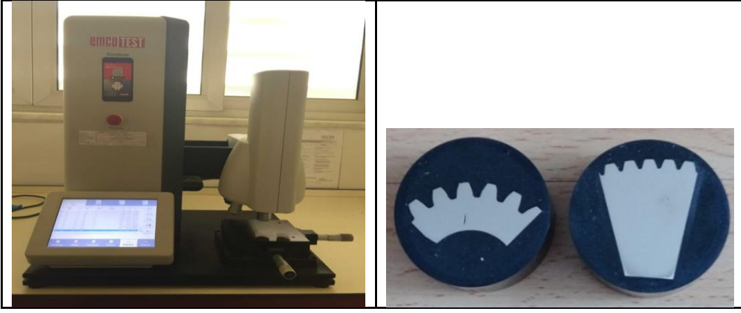
Şekil 2. Sertlik ölçme cihazı ve örnek numuneler.
