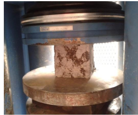
Resim 1. Basınç dayanım testi yapılan numune (Compressive strength experiment on a sample)
