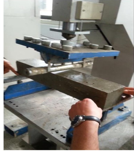
Resim 2. Eğilme dayanımı deneyi yapılan numune (Flexural strength experiment on a sample)
