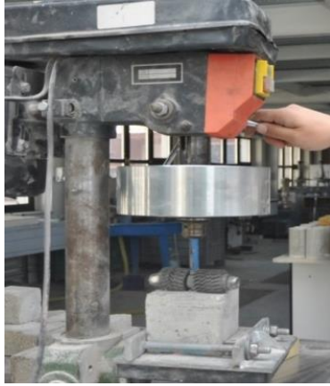
Resim 3. Aşınma direnci deneyi yapılan numune (Abrasion resistance experiment on a sample)
