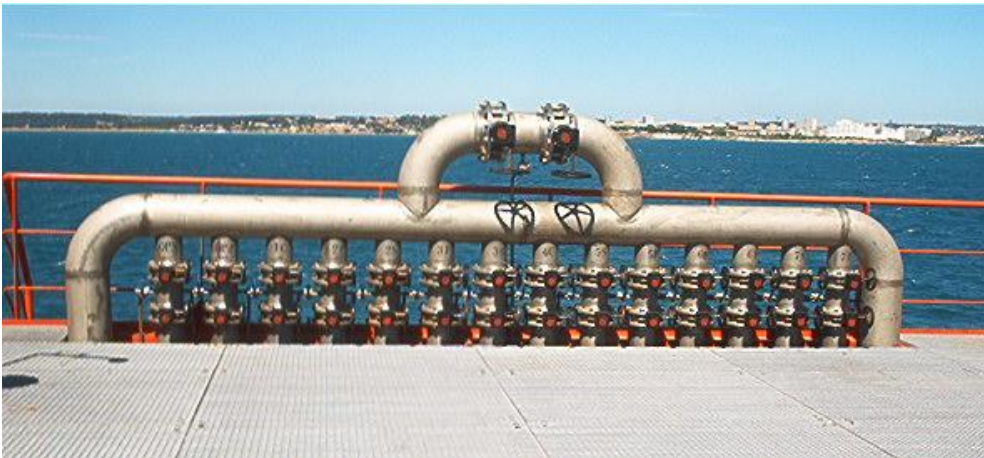
Foto 2. Kargo manifoldu doldurma boşaltma istasyonu. CL den borda ya bakış.
