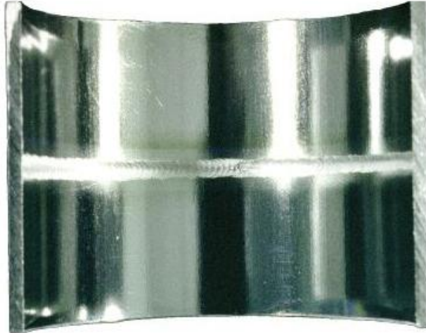
Foto 8. Kabul edilebilir uygun kaynak kesiti
