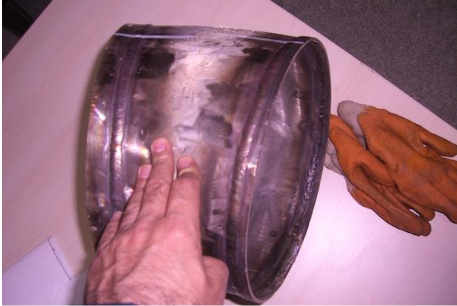
Foto 4. Paslanmaz özelliği kaybolan, nüfuziyet noksanlığı, yanma ve süreksizliği olan kargo devre kesiti
