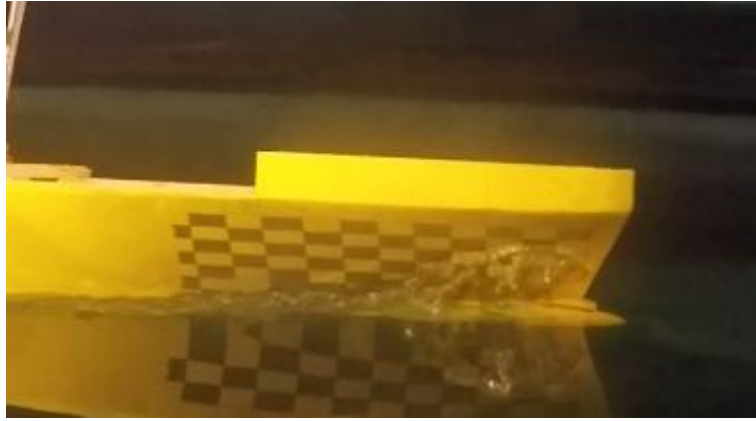
Şekil 12. Takıntılı gövdedeki sprej tepe noktası (Su hattından 10 mm yükseklik)
