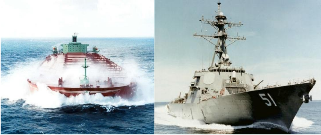
Şekil 1. Dolgun ve narin gemilerde oluşan baş dalgaları [9].
