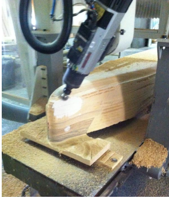
Şekil 12. Bir yük gemisi modelinin bitirme işlemi.
