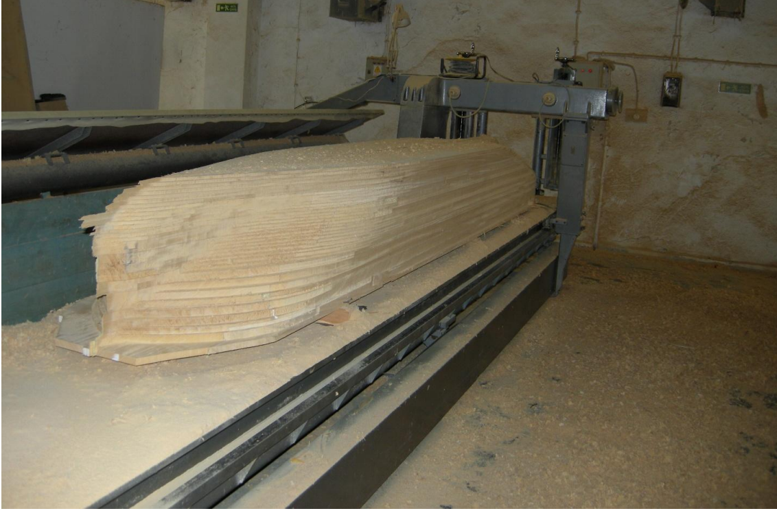
Şekil 3. Su hatlarını takip eden analog freze ile model imalatı.
