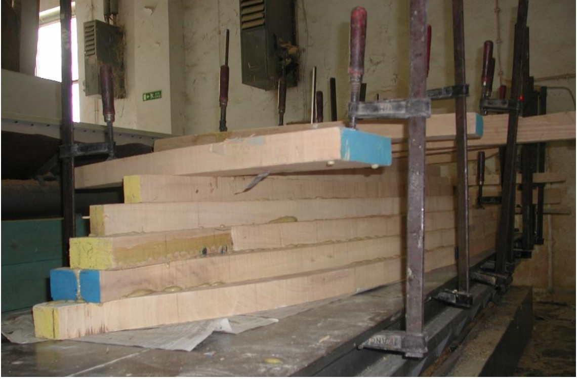
Őekil 4. Ham blok iin aŐap katmanların yapıŐtırılma sreci
