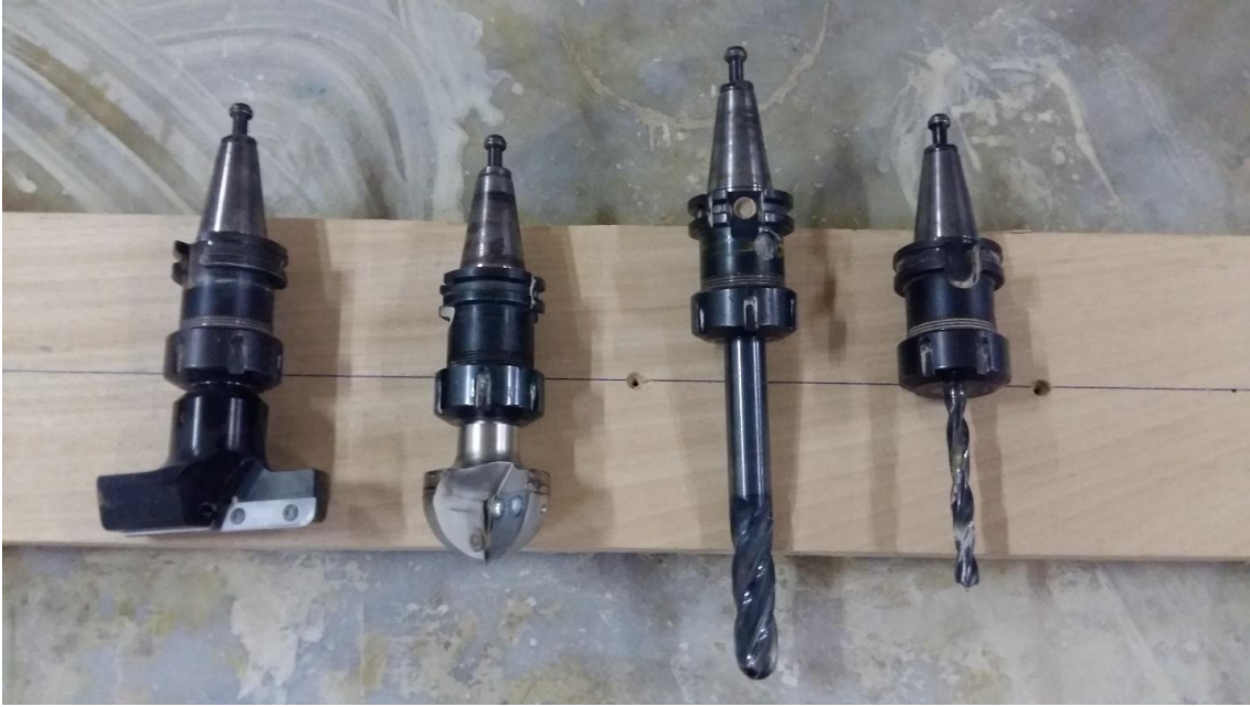
Şekil 6. CNC freze makinasında kullanılan başlıca kesici bıçaklar.
