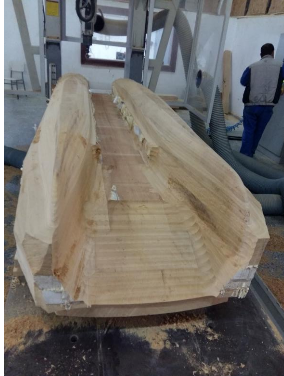
Şekil 13. Kaba işlemesi bitmiş bir ikiztekne.
