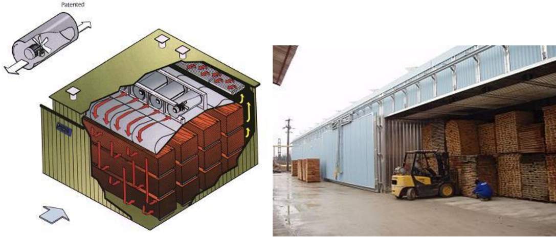
Şekil 1. Teknik Kurutma Fırını Şematik Görüntüsü
