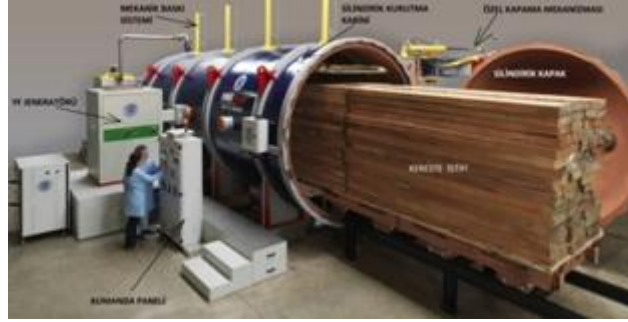
Şekil 3. Yüksek Frekanslı ve Vakumlu Kurutma Fırını
