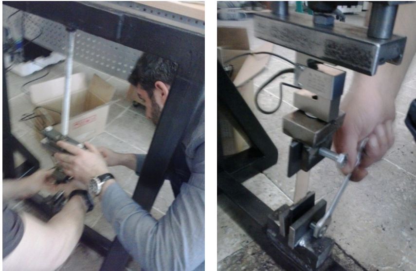
Şekil 20. Numunelerin mengenalere tutturulması.
