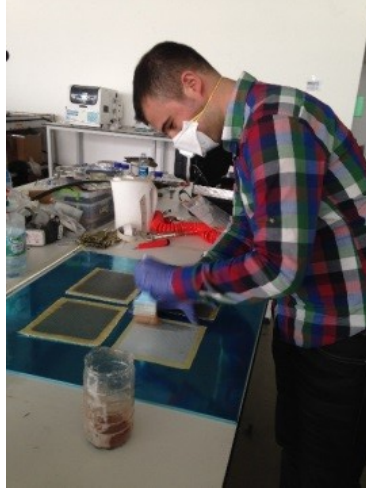
Şekil 1. Elle yatırma yöntemi.
