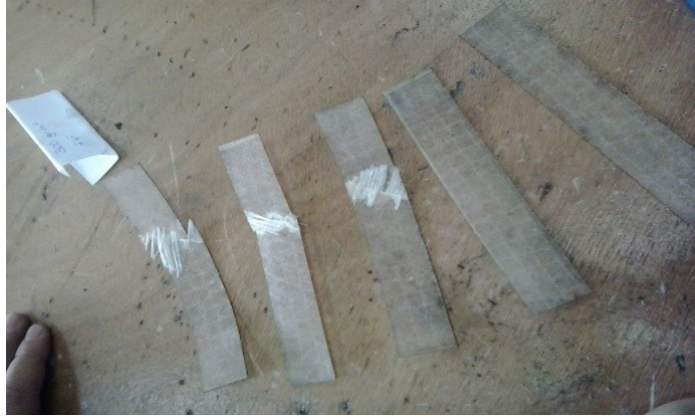
Şekil 22. Numunelerin kopma şekilleri.
