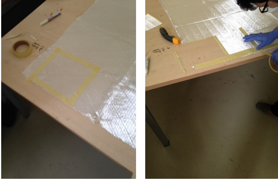
Şekil 9. Numunelerin uygun ölçülerde işaretlenmesi.
