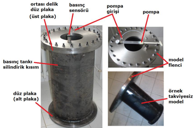
Şekil 3 : Deney düzeneği ve bileşenleri
