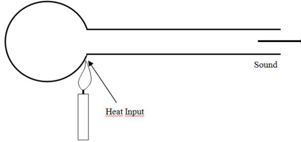
**Figure 1 :** Sondhauss Tube
