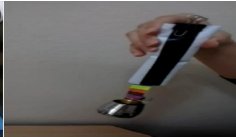
Fotoğraf 1.2.El yapımı dinamometre
