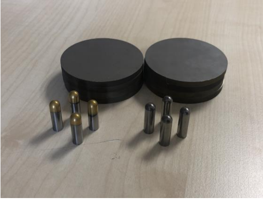
Şekil 3. Ti6Al4V ve AISI 1045 çeliği örnekleri ile kaplamasız WC-Co ve TiN kaplamalı uçlar
