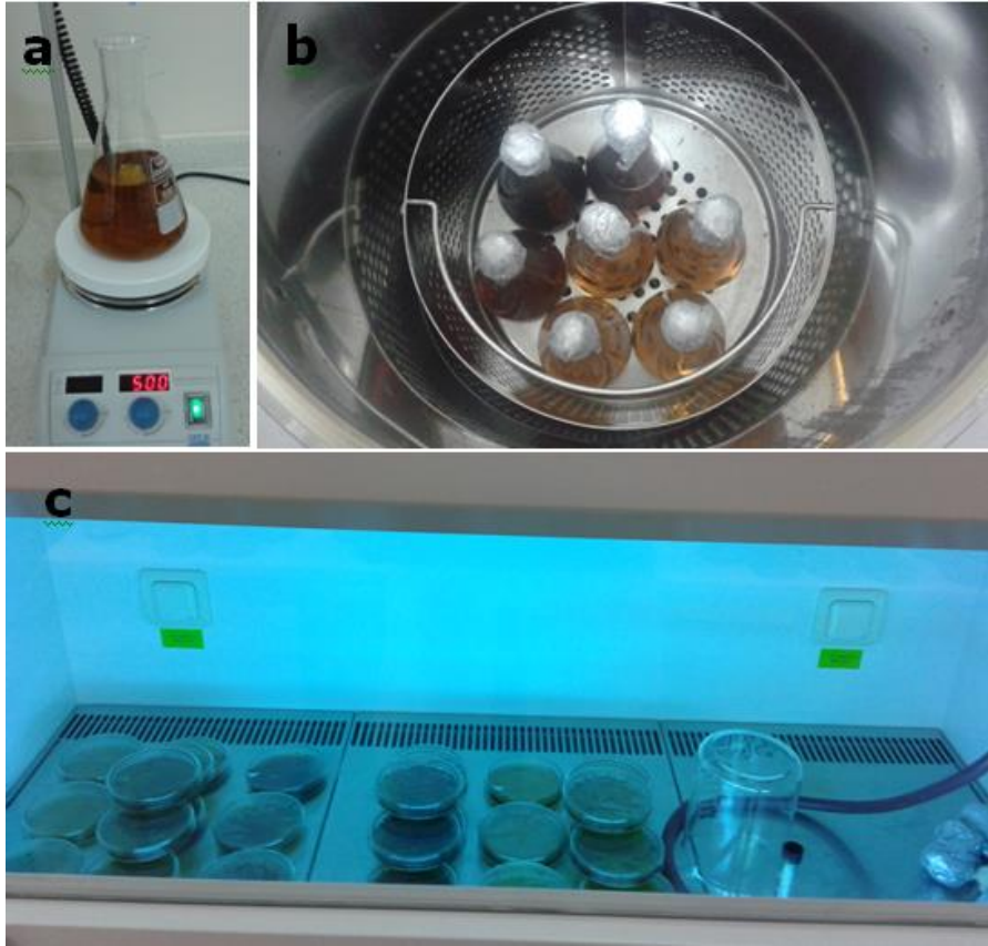
Şekil 1. a: Saf su ile hazırlanan besi yeri, b: Otoklavda steril edilen besiyerleri, c: Besiyerlerinin UV altında sterilizasyonu
