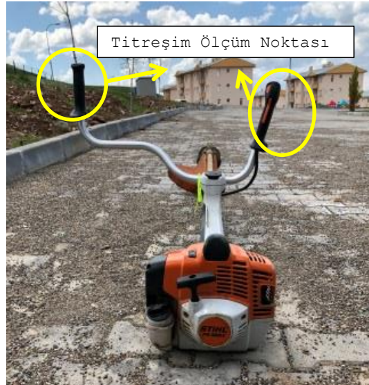
Şekil 4. Motorlu tırpanın ölçüm noktası (Figure 4. The measuring point of the motor scythe)
