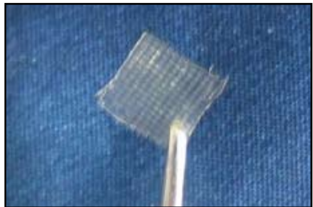
Resim 3 Fabrikasyon olarak rezin emdirilmiş örgü cam fiber
