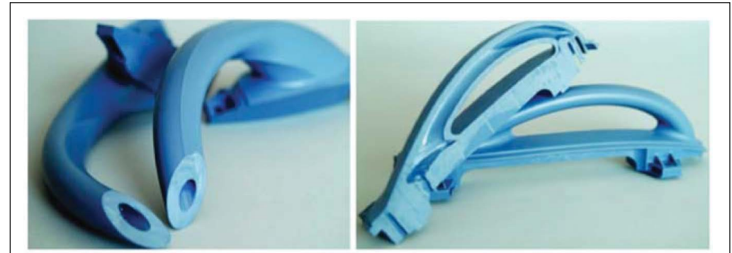
Şekil 15. GIT ile Üretilen Kapı Kolu
