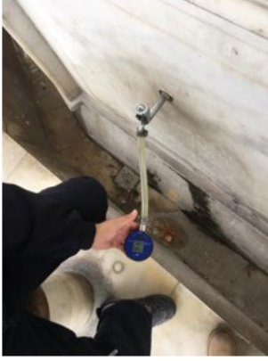
Şekil 6. Çalışma alanında basınç ölçme çalışmaları
