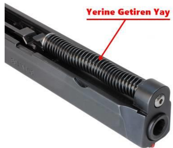
Şekil 2. Yerine getiren yay takılı örnek bir tabanca kapağı (URL-2) Figure 2. A sample pistol slide with a recoil spring (URL-2)
