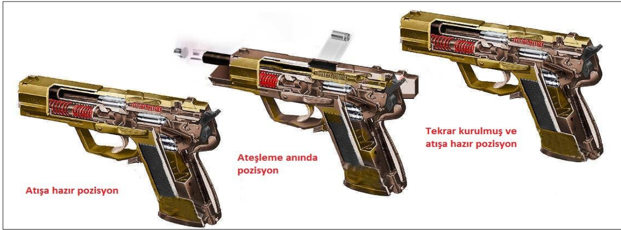
Şekil 1. Tabancaların çalışma prensibi (URL-1) Figure 1. Working principle of pistols (URL-1)
