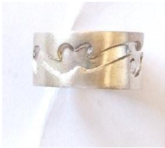
Şekil 3. Gümüş astar üzerine kesilmiş desenin kaynatılmış hali (Yüzük Uygulaması)
