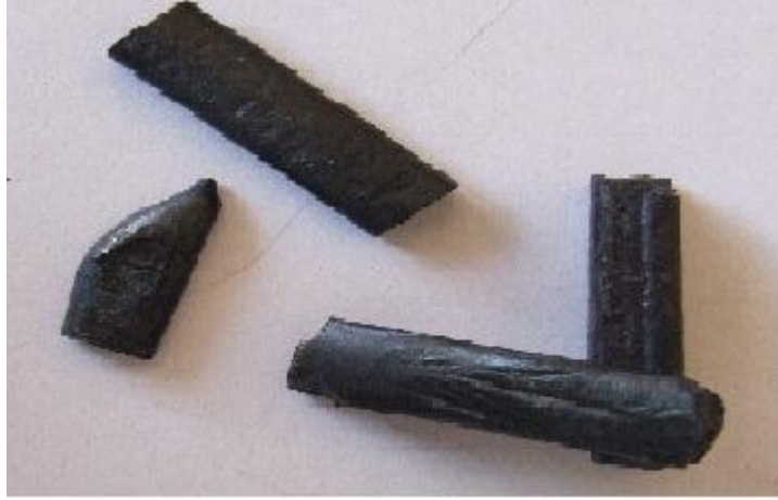
Şekil 5. Çubuk kalıba dökülmüş savat hammaddesi (Figure 4. The raw material bar molded niello)
