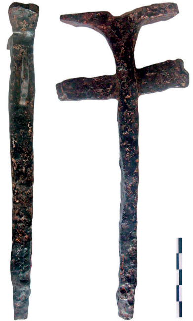
Res. 23 Duvardan ısıtma sistemine ait demir çivi örneği.
