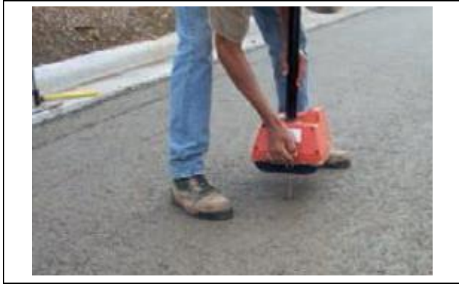
Şekil 3. Yol kesitinde yoğunluk ölçümünde kullanılan nükleer cihaz [10].
