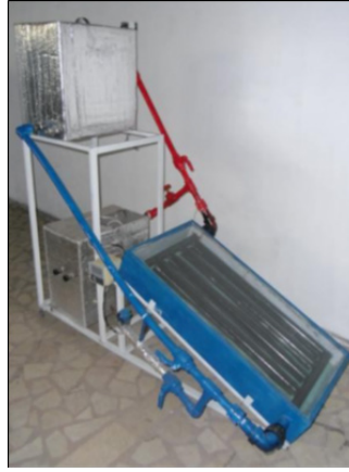
Şekil3. Doğal Dolaşimli Sistem ve Sıcaklık Kontrollü Sistem
